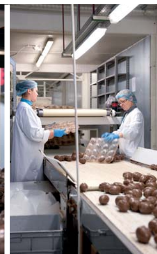
Na de afkoeling worden ze door de medewerkers ontvormd .
