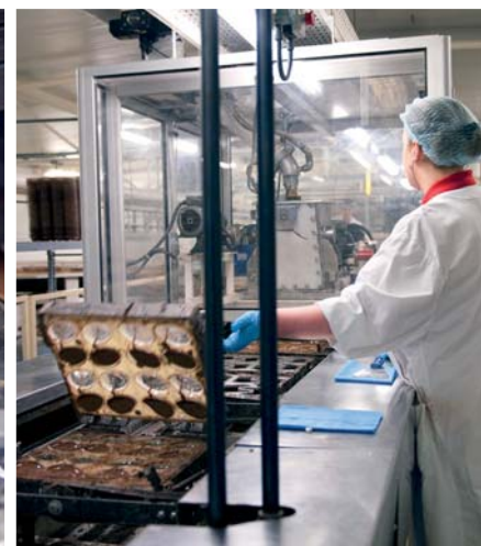
De chocolade wordt in opgewarmde vormen gespoten en getrild zodat ze gelijkmatig verdeeld wordt over de twee helften.
