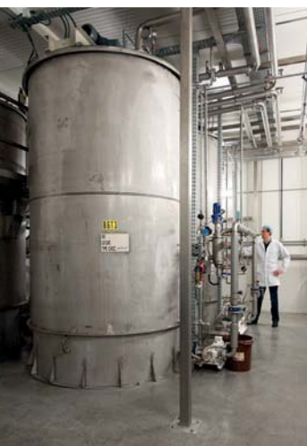
De chocolade komt gesmolten toe en wordt bewaard in verwarmde tanks.
