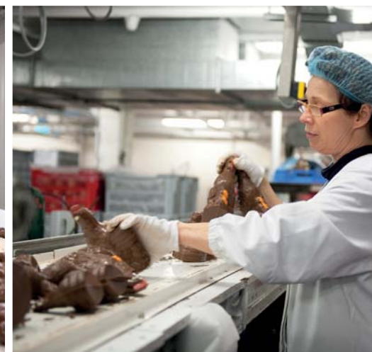
Het uitzicht en het gewicht van de figuurtjes wordt gecontroleerd . Diegene die niet voldoen, worden van de band gehaald.
